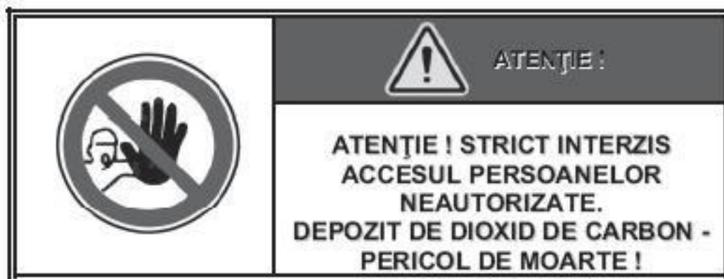
Figura 14.2. Indicator pentru avertizare pentru spațiile în care se depozitează butelii cu dioxid de carbon
